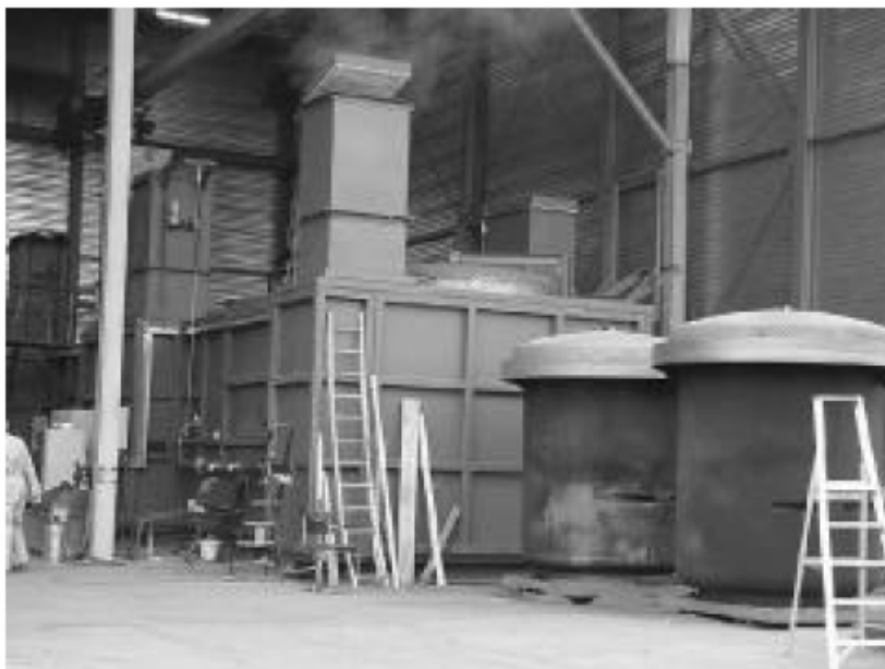
תמונה 11- כבשן twin-retort system של חברת CARBO GROUP מימין ניתן לראות את שני מיכלי הקיבולת לגזעי עצים (מקור 16).
