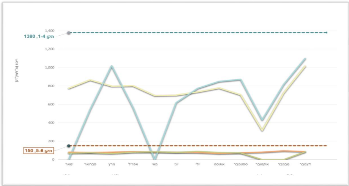
תרשים 12 ריכוז יממתי מירבי של גופרית דו-חמצנית (SO 2 ) מארובות אורות רבין לשנת 2023
