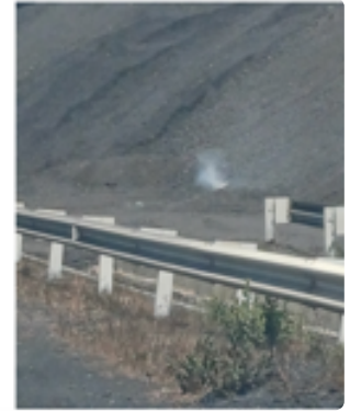
תמונות 1-4: בעירות פנימיות בערימות הפחם באתר "אורות רבין" שאותרו במהלך סיורי הפיקוח, וביצוע הרטבת הערימות למניעת בעירות אלה.
